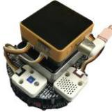
とAndroidタブレット
