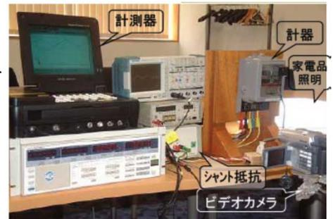
家電の電流・電圧波形測定装置
